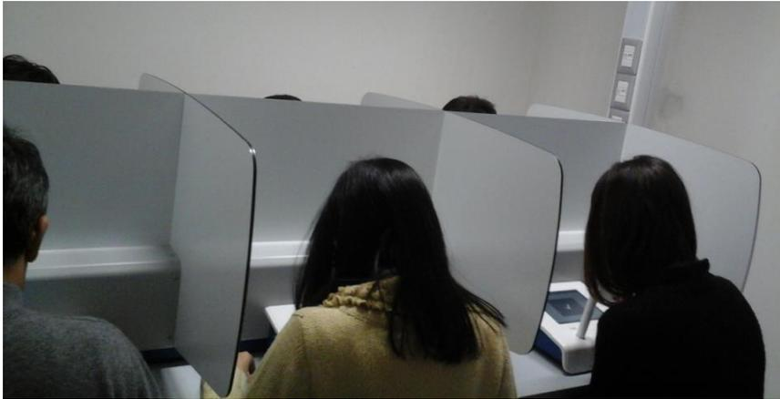
Misure di olfattometria dinamica in accordo alla norma internazionale UNI EN 13725:2004 mediante:
